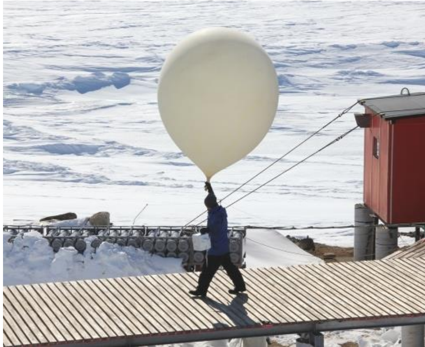
昭和基地でのオゾン観測 気球にゾンデを下げて上空のオゾン量を測定
